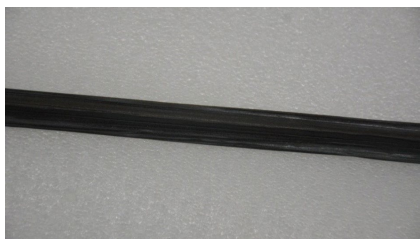
图 8 制备的芯材 Fig.8 Prepared radius fillers
